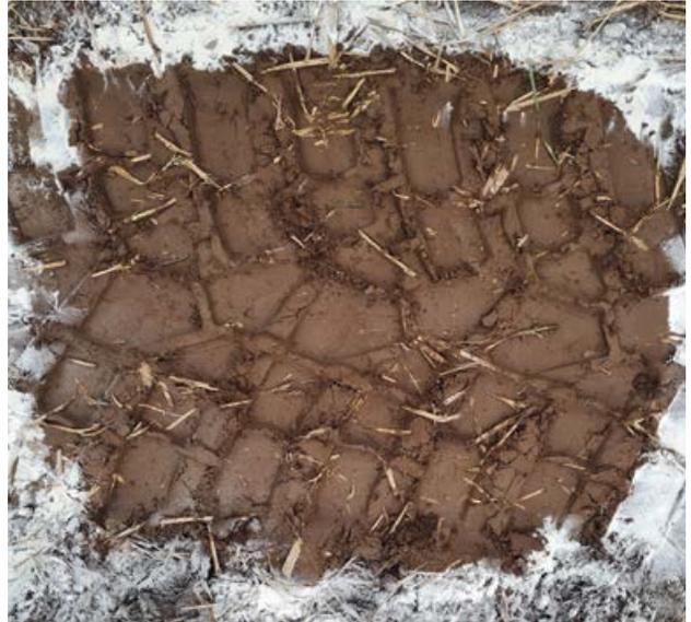
*Umstäubte Radaufstandsfläche bei IP 1,0 bar
